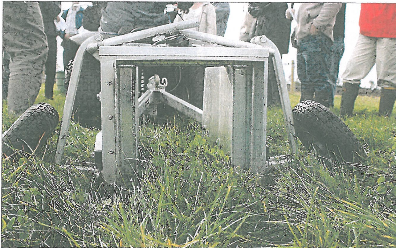
Ved hjælp af lyssignaler måles græshøjden og omregnes til kg tørstof pr. ha.
